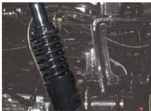
La suspensión de la cabina del Case IH Magnum amortigua los impactos en movimiento hacia adelante, hacia atrás y de arriba hacia abajo. Eso le proporciona al operador una operación más suave en el campo, evitando la vibración durante el trabajo en terrenos irregulares. La mayor comodidad le da libertad para concentrarse en el trabajo y un mayor control del tractor, sin fatiga al final de una jornada larga.
