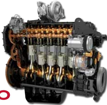
La serie Magnum viene equipada con motores Case IH Cursor 9 de 8,7 litros, 6 cilindros y turboalimentados. La potencia de la serie varía de 235 a 340 caballos. Vienen equipados con el sistema Common Rail, que proporciona una quema más eficiente del combustible, garantizando un consumo más bajo y una potencia superior.
